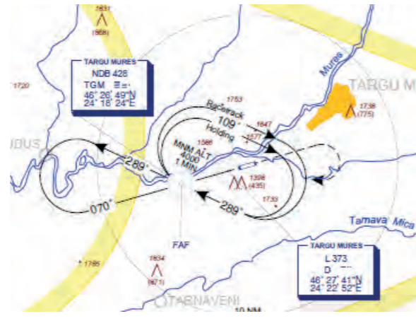
Marosvásárhely (LRTM), NDB megközelítés, RWY 07, C és D sebességkategóriás légi járművek számára
